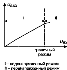
Рис. 10.4. Амплитудная характеристика усилителя: U_{\text{вх}} — напряжение возбуждения на входе усилителя; U_{\text{нх}} — напряжение на нагрузке усилителя
