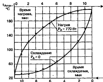
Рис. 14.11. Зависимость максимальной температуры лампы от времени нагрева и охлаждения
