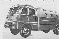
3. Автомобиль для транспортировки молока (шасси «Чепель Д-700»).
