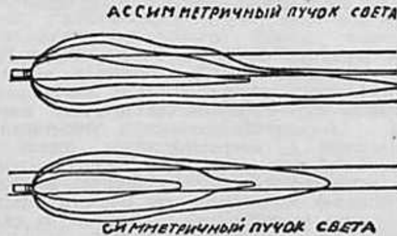
Рис. 2. Расположение пучков света в обычной и асимметричной фарах.
