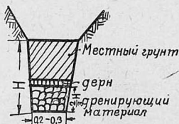
Рис. 5. Понижение при помощи дренажа уровня грунтовой воды
